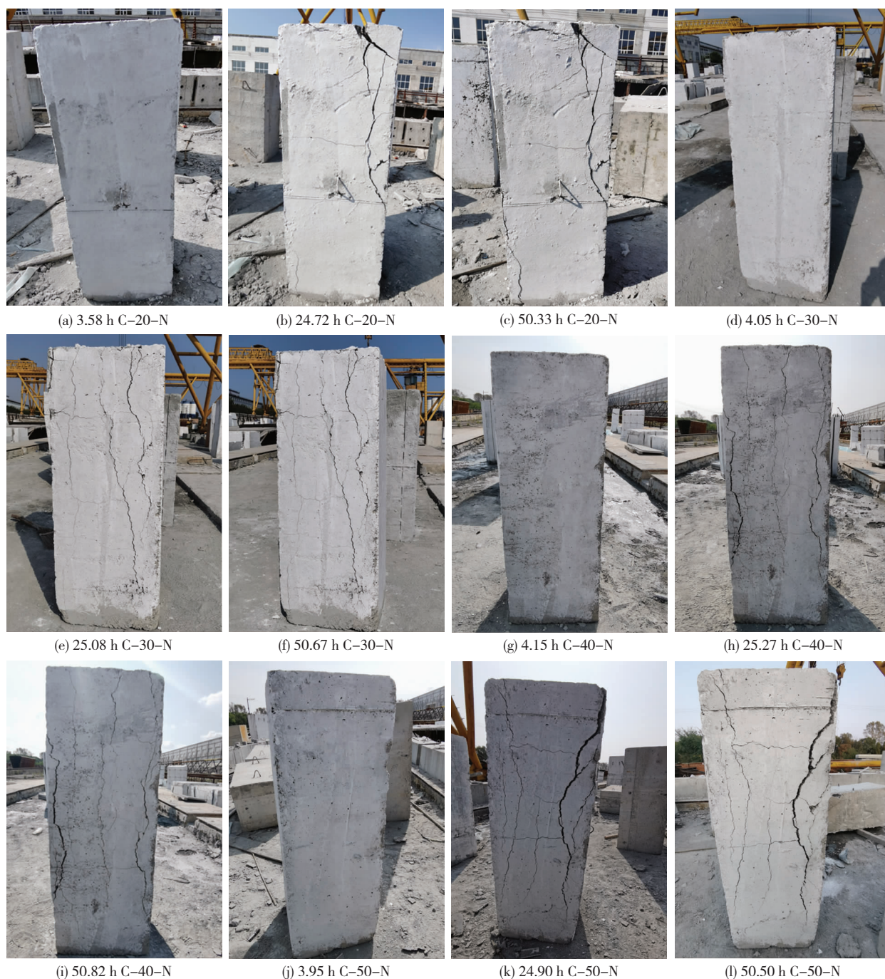
图5 不割断箍筋混凝土柱侧面破碎过程
