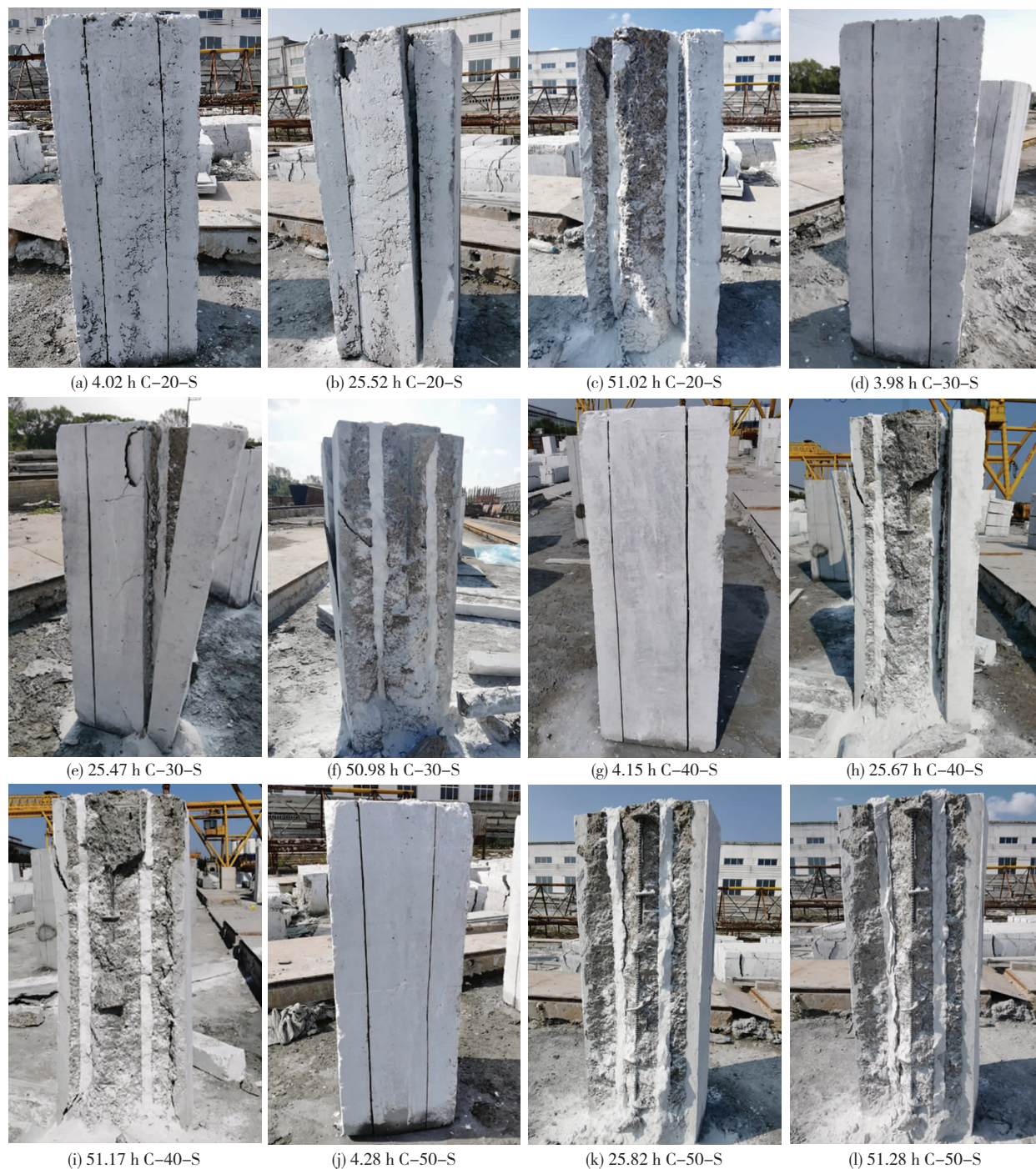
图 11 割断箍筋混凝土柱的侧面破碎过程
